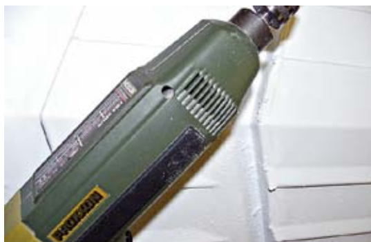
▲ Mit der Minibohrmaschine wurden die Kanten der Stufen im Rumpfboden nachbearbeitet
