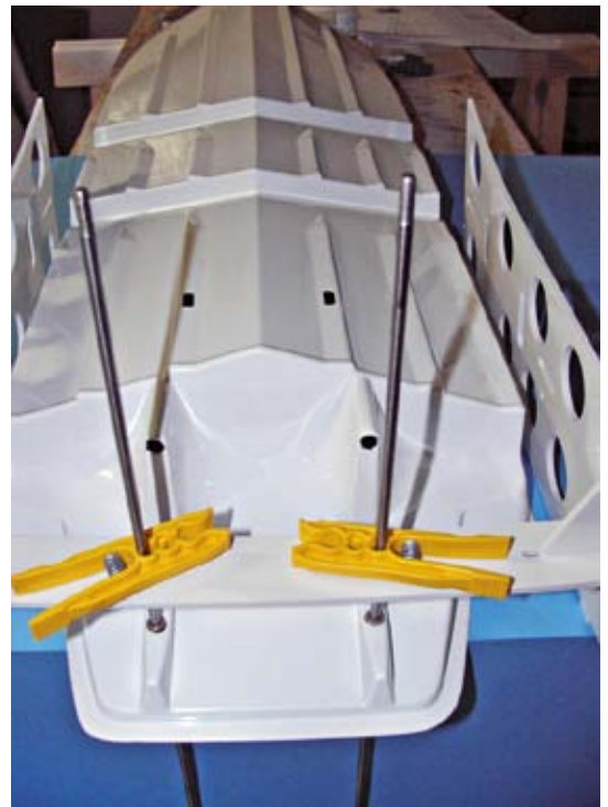
▲ Zur Ausrichtung der Ruderkoer liegt eine Schablone dem Bausatz bei
